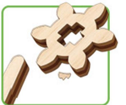
**ENG** Clean the burrs on the parts using the universal "Helper" (H) instrument. **UKR** Очистіть задирки на деталях за допомогою універсального інструменту «Helper» (H).
