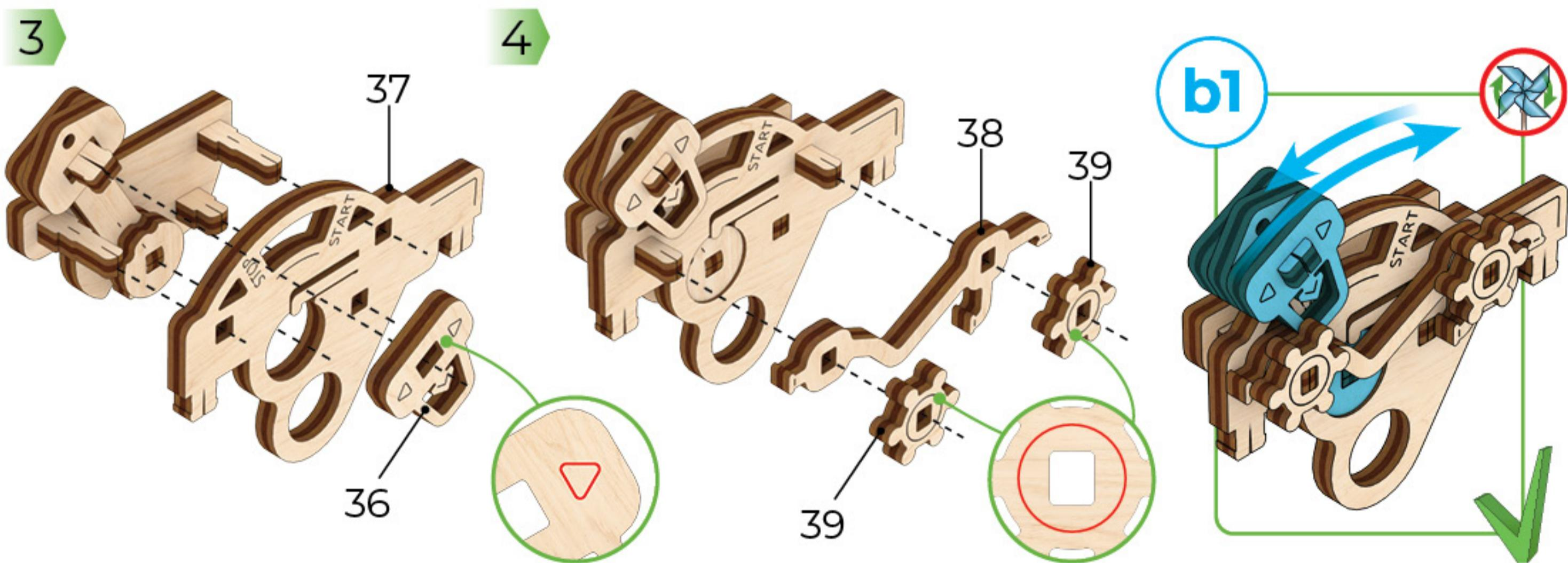
ENG The part should be easily rotated (moved). UKR Деталь повинна легко крутитися (рухатися). FRA La pièce doit tourner (se déplacer) aisément. DEU Der Teil soll leicht gedreht (bewegt) werden. SPA La pieza debe ser fácil de girar (mover). ITA Il componente deve girare (muoversi) facilmente. JPN 部品はしっかりと動かなければなりません。 CHI 此部件必须容易的旋转(移动) POL Element powinien łatwo się kręcić (poruszać się). POR A peça deve ser facilmente girada (movida). KOR 활하게 움직일 수 있어야합니다.
