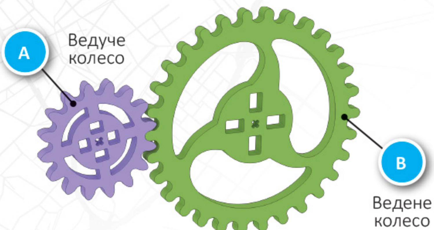
Рис. 7. Зубчаста передача
