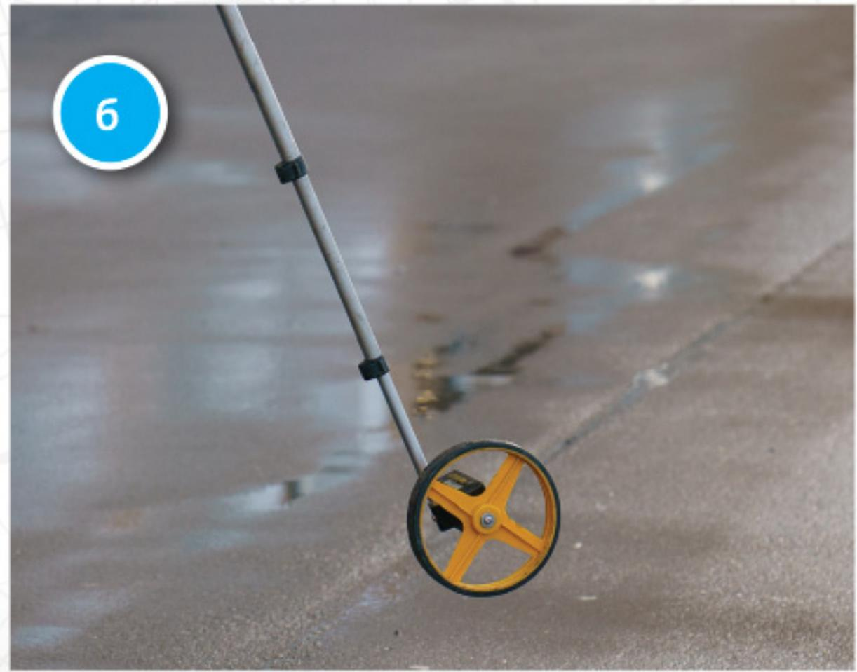
Мал. 5. Вимірювання відстані польовим циркулем (а) та дорожнім колесом (б)
