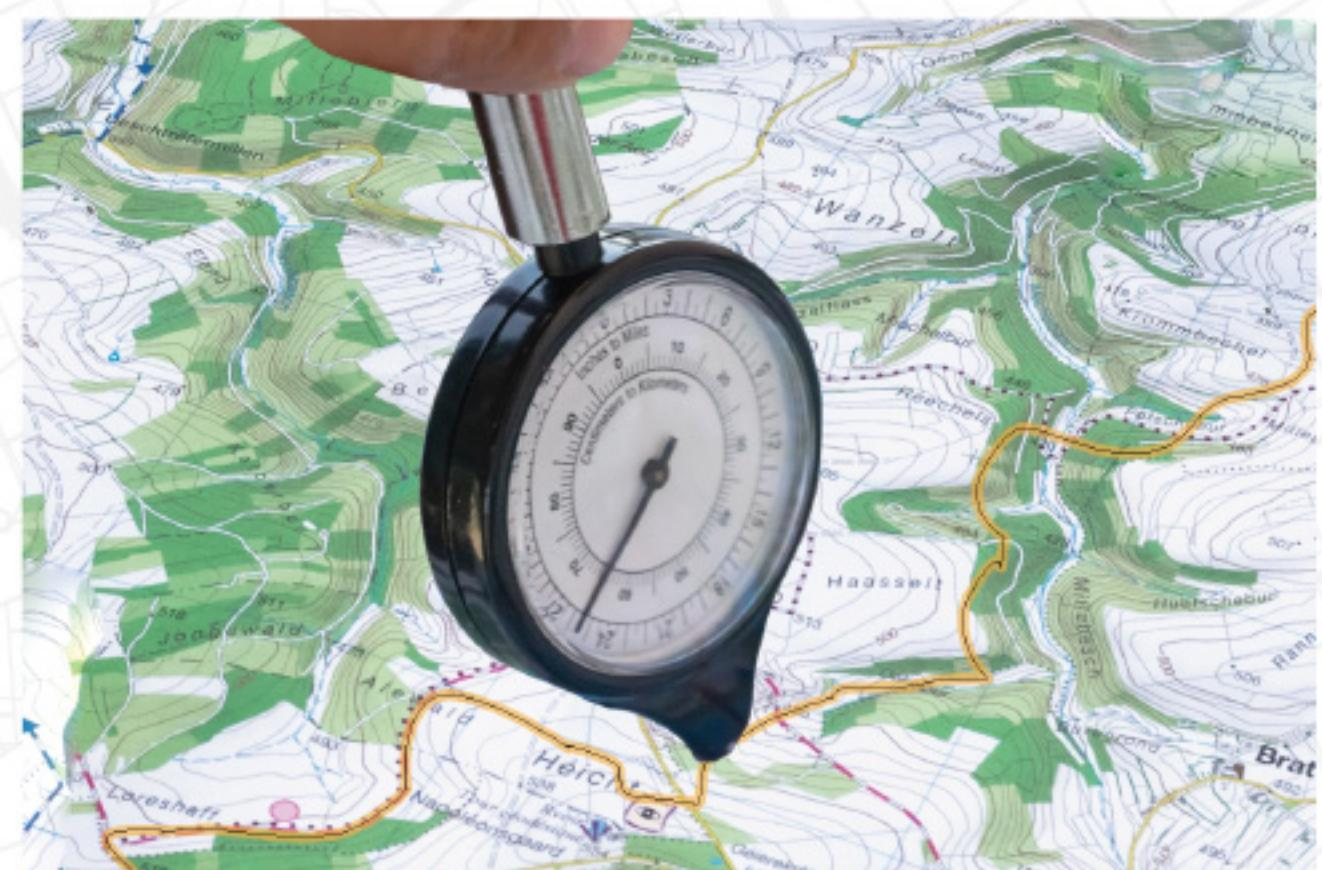
Мал. 4. Вимірювання ліній курвіметром
