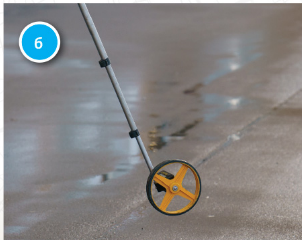
Рис. 5. Измерение расстояний «полевым циркулем» (а) и «дорожным колесом» (б)
