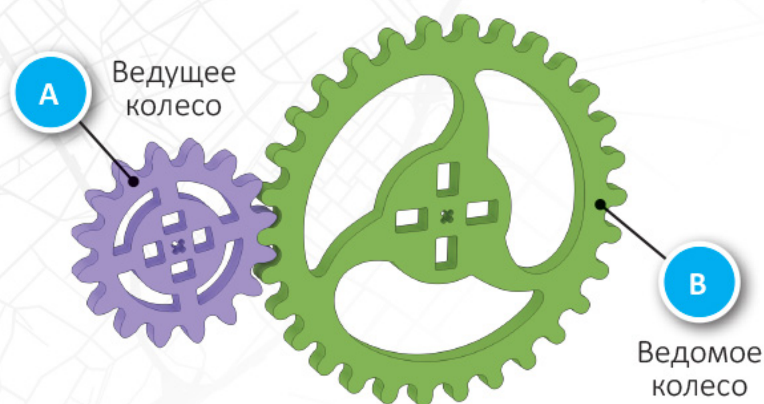
Рис. 7. Зубчатая передача (пример зацепления зубчатых колес)
