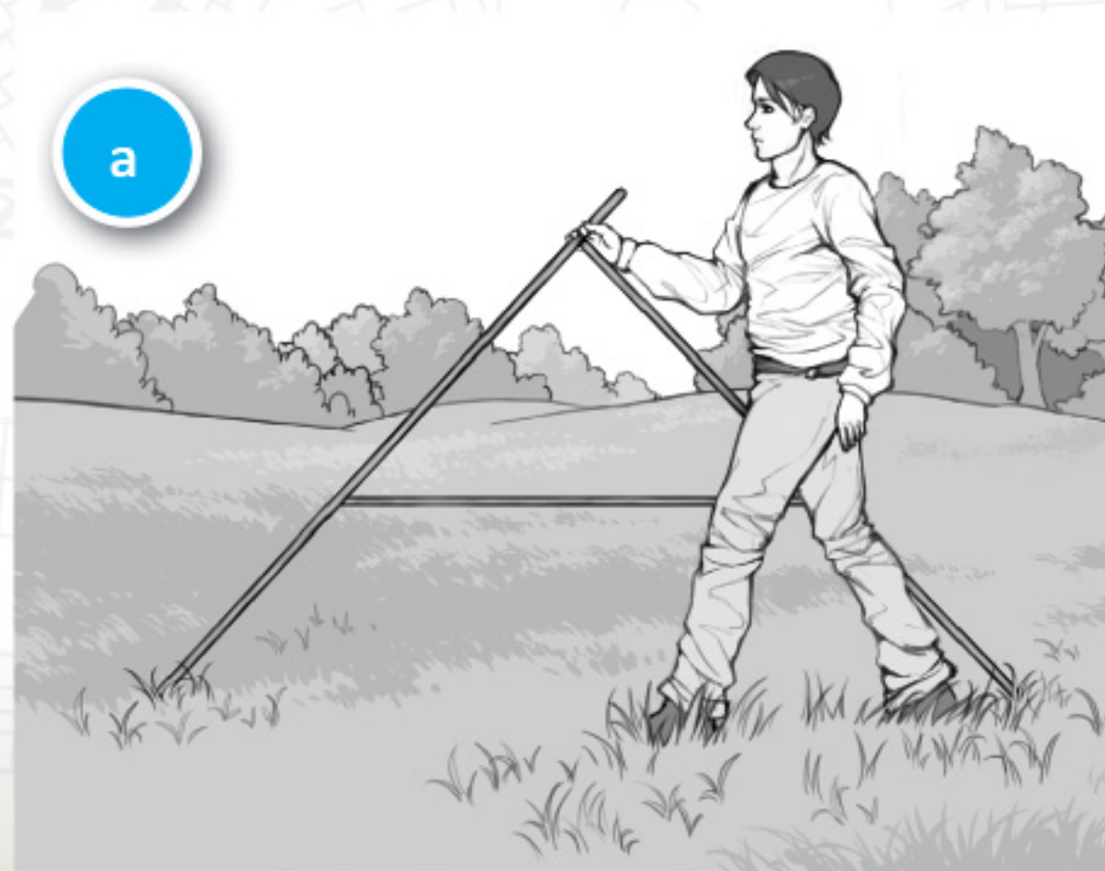
Рис. 5. Измерение расстояний «полевым циркулем» (а) и «дорожным колесом» (б)
